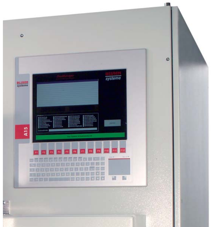
IPC eingebaut im Schutzgehäuse eines Etikettendruck-Spender
